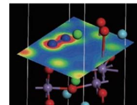
触媒表面における窒素酸化物の浄化プロセスを電子密度分布から見ている。2つの窒素酸化物が、化学反応によって無害な窒素に変化する前駆状態の様子。
