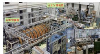
電気推進機開発及び核融合プラズマ加熱用イオンビーム開発装置
