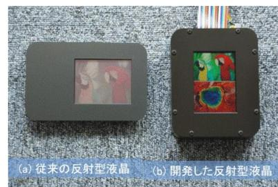
(a) 従来の反射型液晶 (b) 開発した反射型液晶
