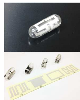
飲み込み型カプセルアンテナ ネットワークアナライザ
