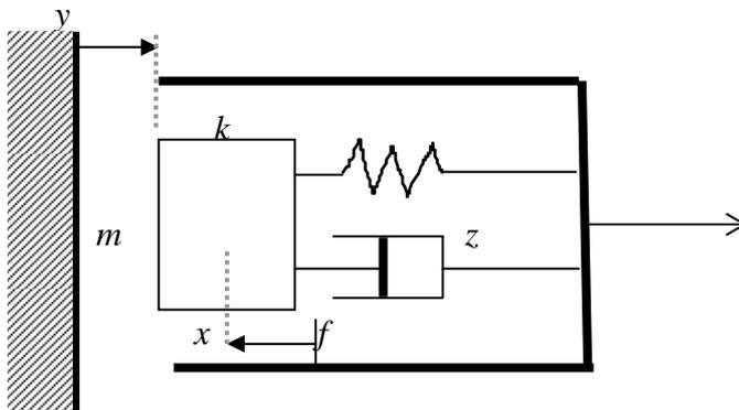
(a) ばね力, 粘性力を含む $z \rightarrow x$ のブロック線図を求めよ.
