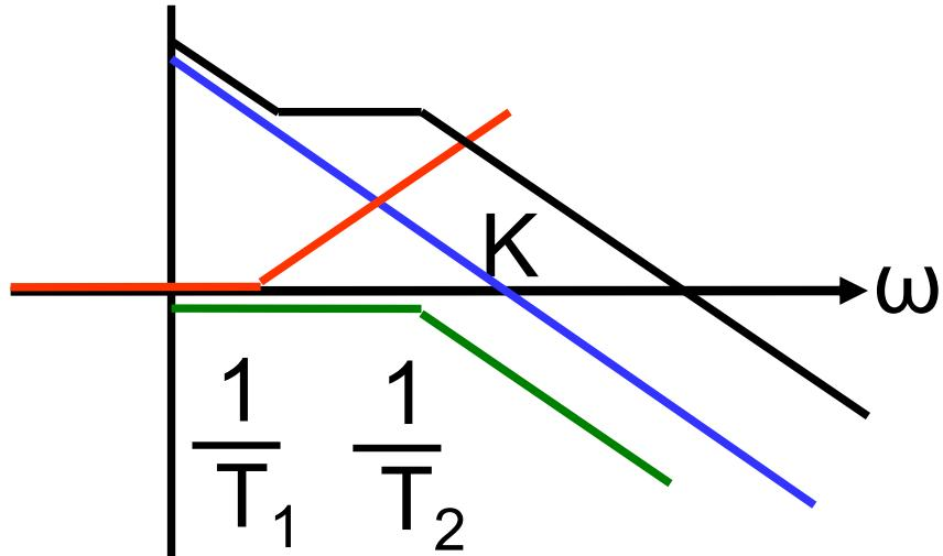
$\omega < 1/T_1 \Rightarrow g_1$ のみ( $g_2, g_3 = 0$ ). 下降
