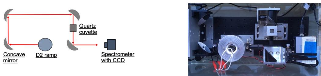
図2：紫外分光器の概略図(左)と写真(右).
