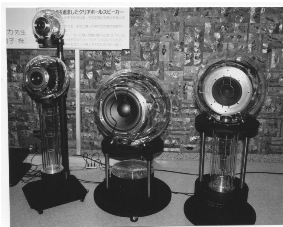
写真 4. 鈴木特殊硝子(株)で製作された球形硝子を使用したスピーカーシステム（左側は中音用、高音用中音用、高音用、中央は低音用、右側はフルレンジ用）
