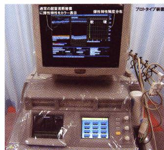
図3：本研究で開発した弾性特性計測可能なプロトタイプ超音波診断装置
