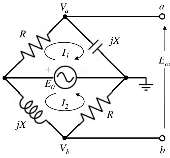
まず端子間の開放電圧  $E_{oc}$  を求める。
